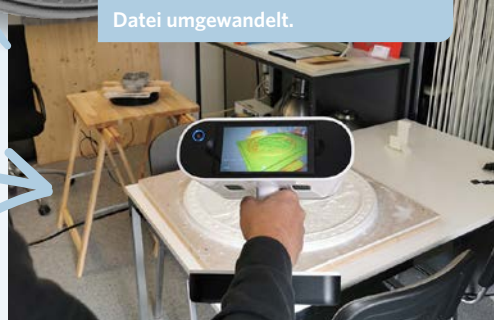
Das Gipsmodell wurde von Markus Risi, We-Scan Stans lasergescannt und dann in eine verarbeitbare CAD Datei umgewandelt.
