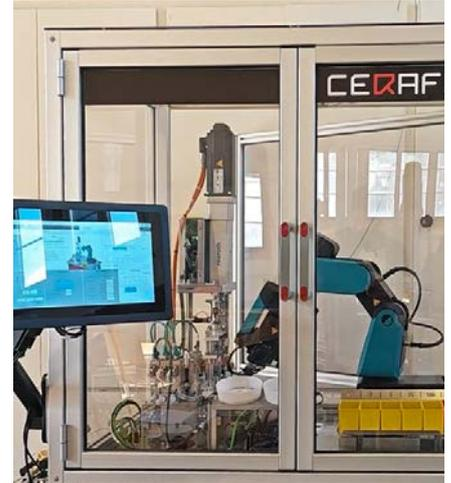
*Ceralex: Maschinenbeispiel mit einem Roboter, welcher eine Presse automatisiert bestückt.*
